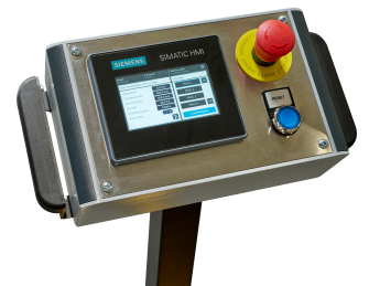
NC SIEMENS mod. MTP-400
