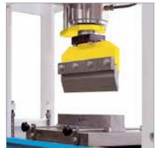
Abkantwerkzeug mit einer Länge von 415 mm
